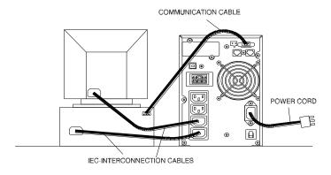
Fig. 3 Esempio di collegamento di un UPS
